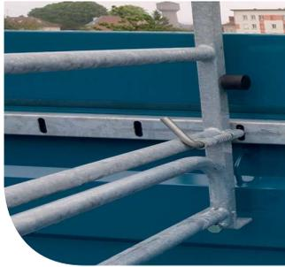
2 / Cloison à déplacement sur rail réglable multi-positions en version ajourée ou tôleée.
